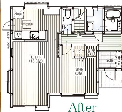
もともと窓側に面していたキッチンを対面式に大改装。リビング横にあった和室のスペースを狭めて、その分リビングの広さを確保しました。部屋の拡張工事にはしっかりと調査と判断が必要ですが、今回は柱を抜いた分天井に補強を入れています。キッチンに入れたダウンライトも雰囲気を明るくだけでなく、空間をスッキリさせてくれていますよね。
